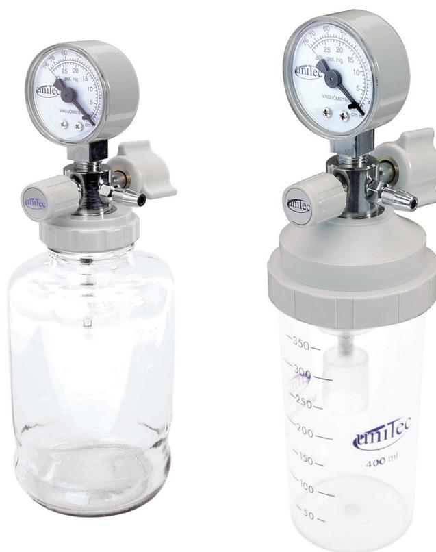
Aspirador para rede de vácuo com tampa de nylon injetado na cor cinza, manômetro de 0 a 76 cmHg / 0 a 30 pol Hg, conexão de entrada e botão de controle de aspiração na cor do gás, conforme norma ABNT, bóia de segurança que impede a passagem da secreção para rede e frasco coletor.
